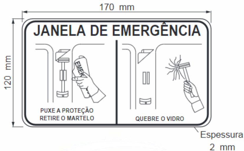
Figura 14 – Modelo de adesivo para instruções do dispositivo de destruição. Fonte: Norma ABNT nº 15. 570 (2021).
