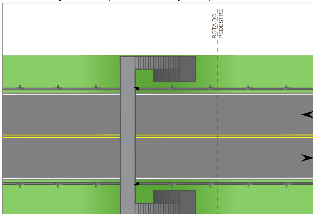
Figura 18 – Dispositivo de contenção sob passarela.
