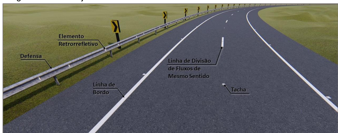
Figura 11 – Utilização de Elementos Retrorrefletivos e Marcadores de Alinhamento.
