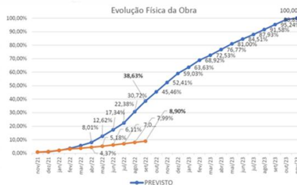
Figura 8 – Exemplo de gráfico de obra com grande atraso em relação ao planejado
